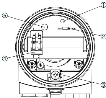
Отсек электроники и подключения - двухпроводный выход
